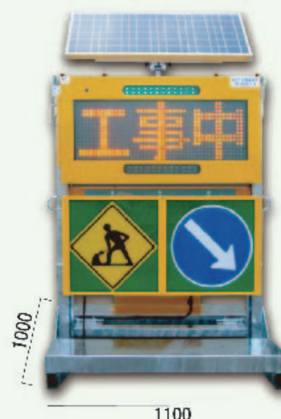
SD-1214 ●SIZE: W1100×H1620(2020)×D1000mm ●重量: 約130kg これまでの製品よりもさらなる小型化・軽量化に成功。視認性アップ。ソーラーパネル・バッテリー電源を採用。大幅なコスト削減に貢献。無電状態下においても、最大で5日間の動作保障。 3面表示 昇降 白黒表示 レンタルOK P23へ
