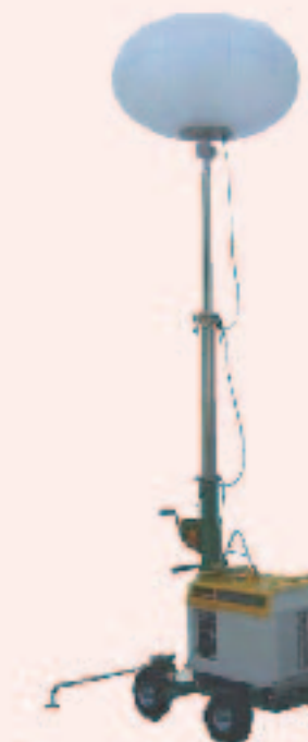
バルーン投光機 (911) バルーン直径1140mm 電圧 100V メタルハイド1000w×1灯 L100×840×1800mm(収納時) マスト最大高4185mm
