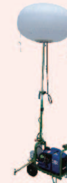
バルーン投光機 新りたみ式 (912) バルーン直径850mm 電圧 100V メタルハイド400W×1灯
