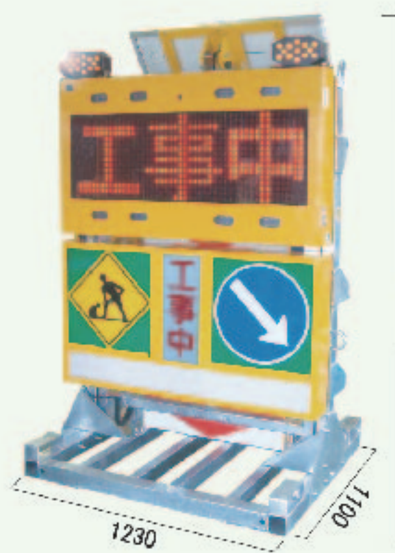
SD-1402 ●SIZE: W1230×H1840(2750)×D1100mm ●重量: 約200kg 極限まで追求した操作の簡易化。小型化・軽量化により通常の2車面だけでなく軽トラックにも搭載可能。既存製品よりもLED画面の大型化に成功。輝度調節機能付。無日無電状態下においても最大で5日間の動作保障。※バッテリー 満充電13.8Vで点滅表示・標準モード時 3面表示 昇降 白黒表示
