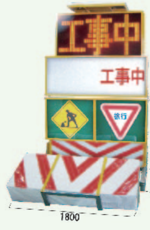
SD-1803-KANTO ●SIZE: W1800×H2500(3400)×D1600mm ●重量: 約450kg これまでにない超大型LED画面搭載。低電力での高輝度LED表示。ケーブルを本体内部に格納し移動・設置時の切断を回避。トラックに同常時に上昇させると地上から4mを超える高さに。 3面表示 昇降 白黒表示 リモコン
