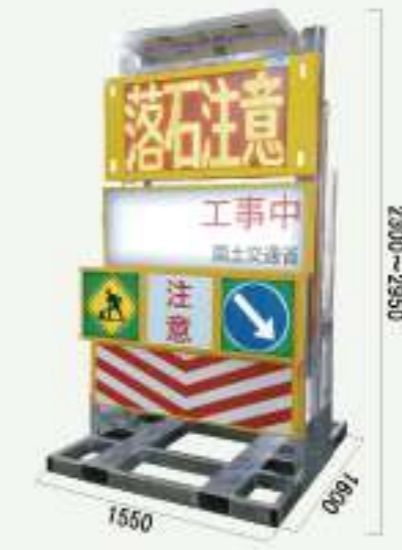
SD-1603 ●SIZE: W1550×H2300(2950)×D1600mm ●重量: 約400kg ソーラー式大画面LED搭載。保管・運搬時に格納可能な大型パネル。トラック等の車庫にも搭載が可能。無日照時でも最大で5日間の動作保障。※標準モード時 ●ソーラー ●3面表示 ●点滅表示 ●動画表示 ●リモコン
