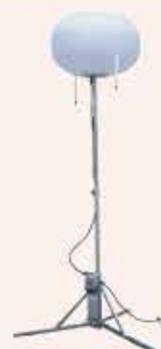
バルーン投光機 三脚式 バルーン直径850mm 電圧 100V メタルハライド400W×1灯
